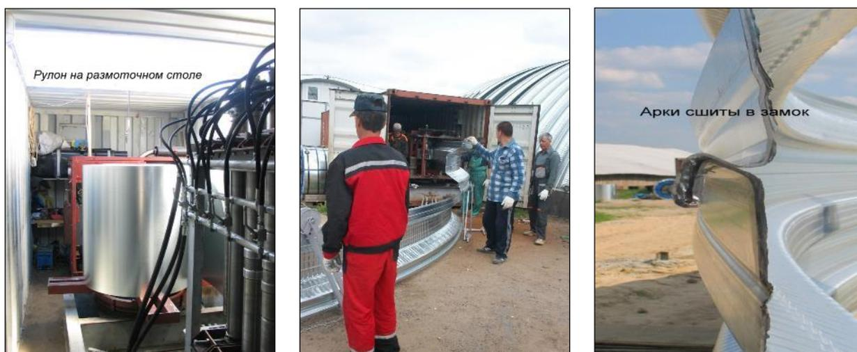
Рис. 1. Изготовление (формовка) строительных элементов (арок).
