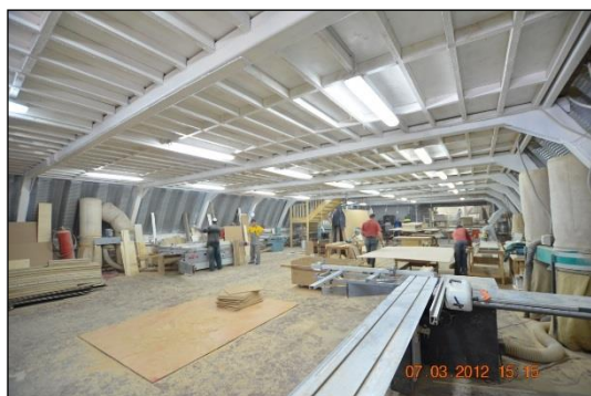
Рис. 7. Вариант утепленного ангара, разделенного по горизонтали на два этажа, для размещения мебельного производства.
